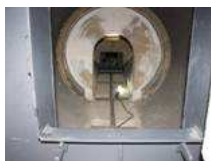
Camera di combustione circolare a ciclone (36-850 kW)
