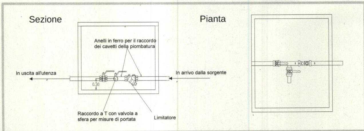
b) realizzazione di un pozzetto di presa presso la sorgente. Realizzazione di foro tarato tra i due pozzi con carico idraulico garantito dallo scarico di troppo pieno. Per tale modalità è necessario un calcolo idraulico da parte di un tecnico.
