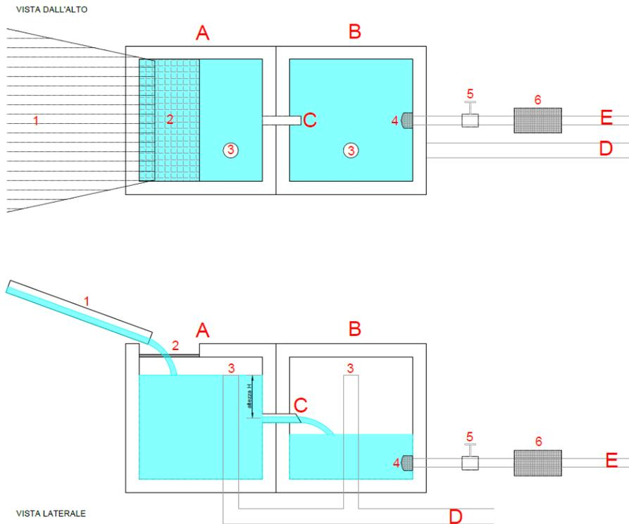
Si prescrive che l'altezza "H" sia fissata a 6 cm e il diametro interno della tubazione "C" a 3,2 cm;
